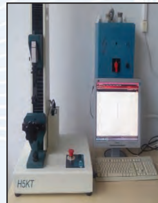
Fig. 149. Aparat pentru determinarea rezistentei fixarii talpii pe incaltaminte
