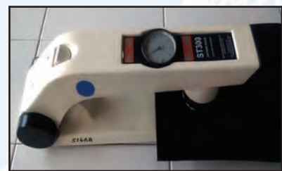
Fig. 152. Aparat pentru determinarea moliciunii pielii
