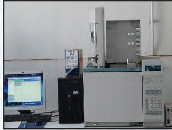
Fig. 119. Gaz cromatograf – ECD – PID, (Hewlet Packard, USA)
