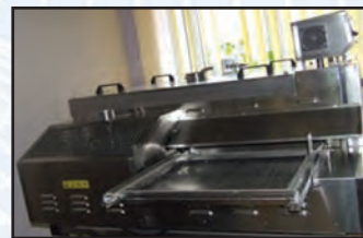
Aparat de uscare-termofixare-condensare-vaporizare pentru operatii intermediare si finale de finisare superioara (ROACHES, Anglia)
