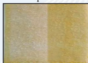
Fig. 54. Tricot bumbac tratat cu TiO_2 si patat cu albastru metilen si metil orange, expus 20 ore la lumina vizibila
