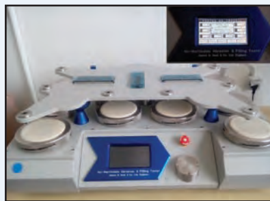
Fig. 151. Aparat pentru determinarea rezistentei la abraziune a tuturor tipurilor de piele prin frecare repetata
