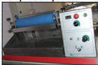
Fulard pentru impregnarea materialelor textile cu substante polimerice si de functionalizare (ROACHES, Anglia)
