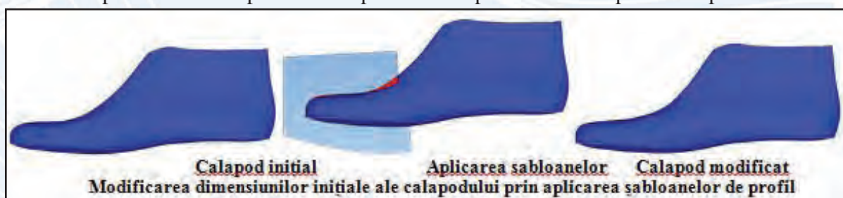
Fig. 85. Proiectarea calapodului experimental
