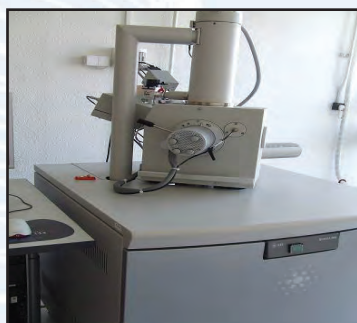
Fig. 116. Microscop electronic de scanare SEM/EDAX, Quanta 200-FEI (Olanda)
