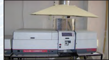
Fig. 123. Spectrometru de Absorbtie Atomica/cuptor de grafit, flacara, VGA (AAS 800, Varian, Australia)
