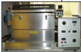
Jigher automat pentru pregatirea si vopsirea materialelor textile in foaie lata (ROACHES, Anglia)
