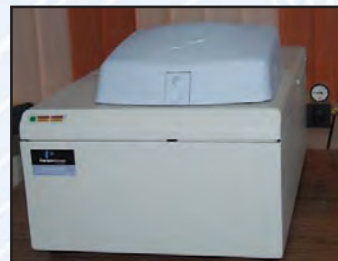
Fig. 133. Calorimetru cu scanare diferentiala, PYRIS Diamond DSC
