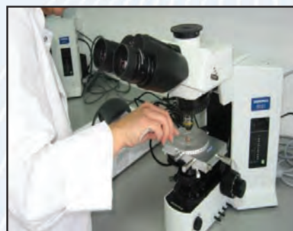
Fig. 117. Microscop optic pentru identificarea fibrelor textile
