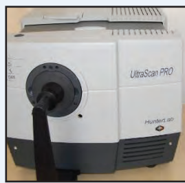
Fig. 136. Spectrofotometru Ultra Scan Pro (Hunterlab, Anglia)
