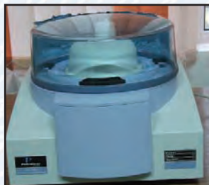
Fig. 132. STA 6000- Analiza simultana termogravimetrica
