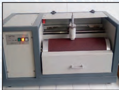
Fig. 150. Aparat pentru determinarea rezistentei la abraziune a talpilor exterioare prin frecare repetata.
