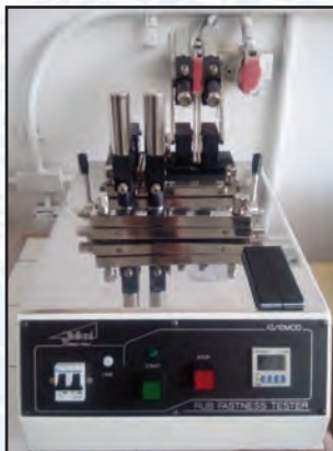
Fig. 147. Aparat pentru determinarea rezistentei vopsirii la frecare
