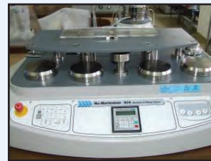
Fig. 126. Echipament pentru determinarea rezistentei la abraziune, Martindale
