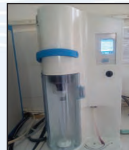
Fig. 143 - Aparat pentru determinarea azotului total UKD 132
