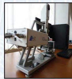
Fig. 130. Echipament pentru determinarea unghiului de contact VCA Optima
