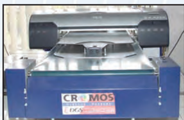
Echipament pentru imprimare textila digitala cu jet de cerneala (DGS, Italia)
