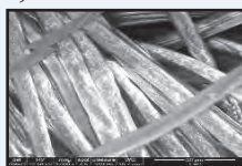
Fig. 61. Poliester/celofibra/ TiO 2 -(1%)Fe-N: c.imagine SEM; d. patat cu albastru metilen, expus 5 ore la lumina vizibila
