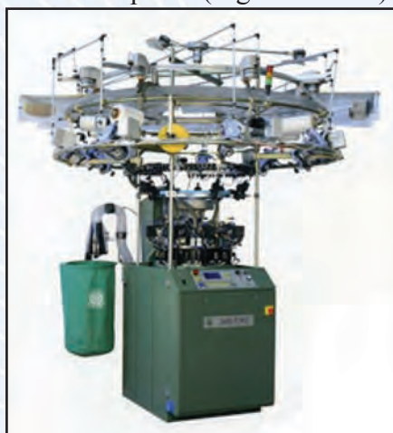
Fig. 16. Masina de tricotat circulara “Seamless” SM8-Top2
