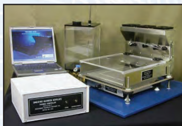
Fig. 128. Echipament pentru masurarea rezistentei termice si a rezistentei la vapori de apa a materialelor textile in regim stationar (Hot Guard, model piele)
