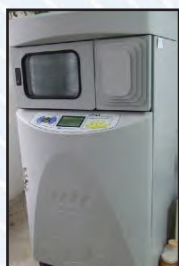
Fig. 134. Echipament pentru determinarea rezistentei la lumina Apollo (James Heal, Anglia)
