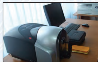
Spectrofotometru dual reflectanta/transmitanta pentru masuratori de culoare (DataColor, Elvetia)
