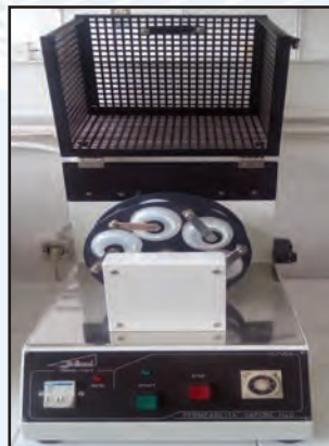
Fig. 148. Aparat pentru determinarea permeabilitatii la vapori de apa
