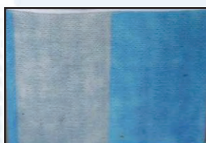
Fig. 54. Tricot bumbac tratat cu TiO_2 si patat cu albastru metilen si metil orange, expus 20 ore la lumina vizibila
