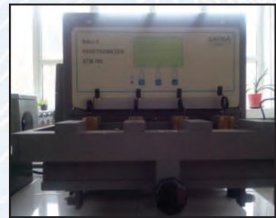
Fig. 146. Aparat pentru determinarea rezistentei la apa in conditii dinamice a pielii finite
