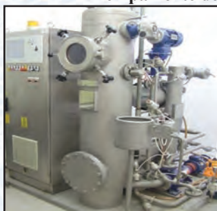
Aparat de vopsire la T.I. tip jet pentru pregatirea si vopsirea materialelor textile in funie (SCHOLL-THEN, Germania)
