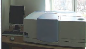
Fig. 122. Spectrofotometru UV- VIS- NIR (Lambda 950, Perkin- Elmer, USA) cu sfera de integrare pentru determinare reflectanta in IR
